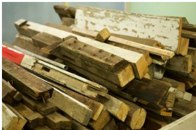
▲加工前の旧池上駅駅舎の古材 当時の駅舎の塗装や釘などが残っています
